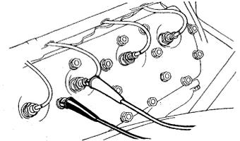
TESTING SPARK PLUG RESISTANCE, OPR. 12405-A
